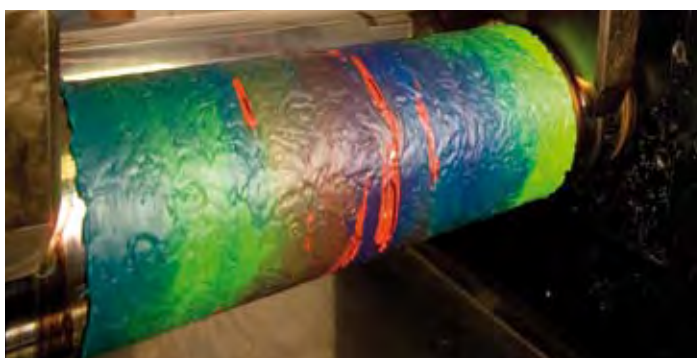
Farbwalze zur schnellen Überprüfung einer Farbausarbeitung und zur produktionsbegleitenden Qualitätsprüfung.
