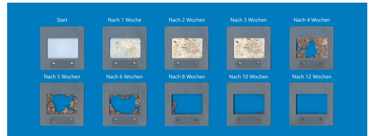
Eine Studie des Instituts „Organic Waste Systems“ in Belgien zeigt, dass eine Plastiktüte aus M-VERA® B5010 mit einer Wanddicke von 288 µm innerhalb von 12 Wochen vollständig durch Bakterien zersetzt wird.
