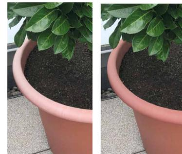
Alle Produkte aus Kunststoff sind Alterungsprozessen unterworfen. Diese lassen sich durch den Einsatz von Additiven verlangsamen. Die Fotos zeigen das Phänomen der Alterung an einem Blumentopf aus PP (sog. Verkreidung).
