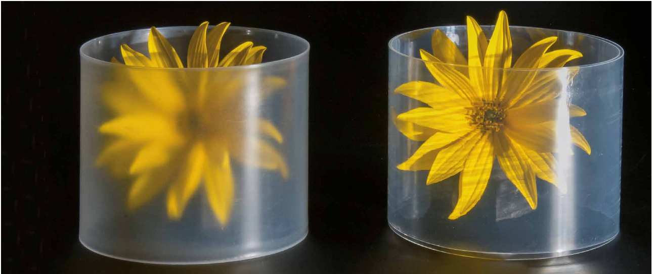
Maximale Transparenz in PP durch optimal auf Extrusions- oder Spritzgussprozess angepasste Clarifierkonzentrate.
