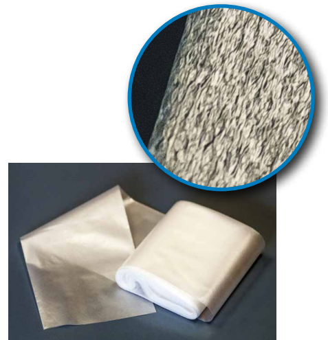
Schaumfolie mit mikrozellulärer Struktur [LDPE mit 2 % AF-Complex® PE 990427 TM 80 µm, Dichte: < 0,5 g/cm 3 ]
